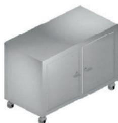
**ARMÁRIO CORTA FOGO:** construído em chapa de aço carbono com pintura. Parede dupla revestida internamente em fibra cerâmica de alta resistência ao fogo. Aberturas laterais de 2" para ventilação. Sistema corta-chamas, bandeja de contenção na parte inferior do armário para evitar contaminação do meio ambiente quando houver derrames. Fechadura de três pontos, dobradiça tipo piano em toda a extensão da porta. Portaria 3214 NR, normas OSHA e NB-98.
